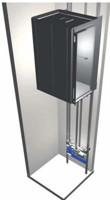
Используемые технологии позволили SODIMAS вывести на рынок ЕДИНСТВЕННЫЙ лифт с силовым агрегатом, установленным в нижней части шахты.
